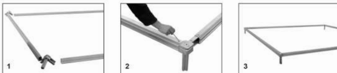
Montaggio del perimetro
